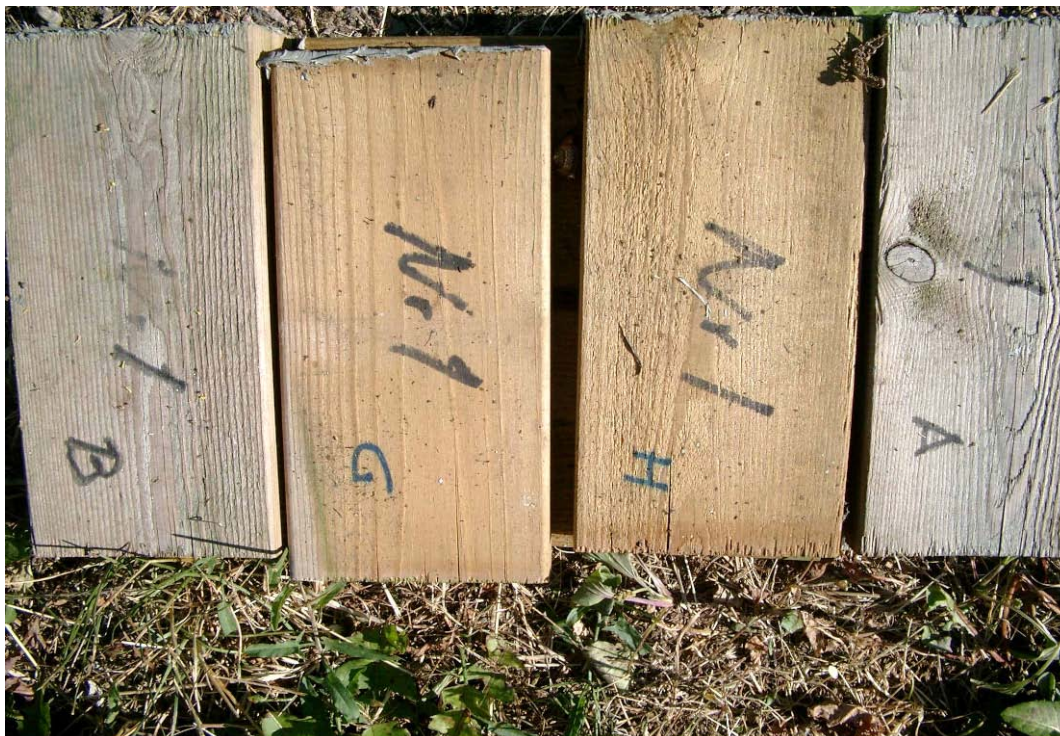
Figur 161. ACQ 1900, uten overflatebehandling.
