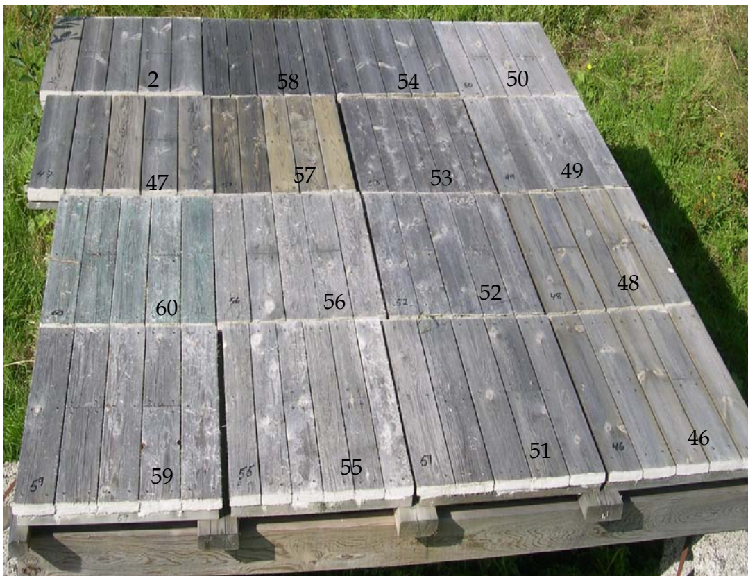
Figur 152. Utseende på prøver med klar overflatebehandling (pluss prøve 2) etter fire års eksponering.
