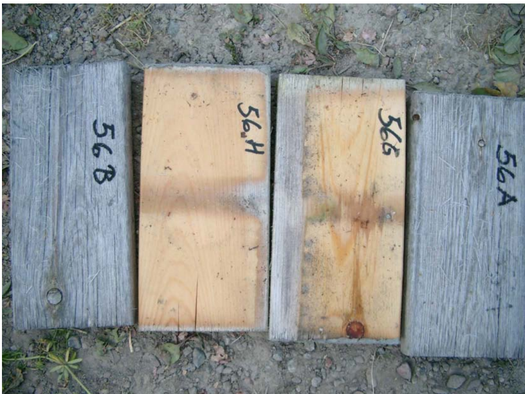
Figur 201. Furu, Gori Pres 10, upigmentert vanntynnbar olje.
