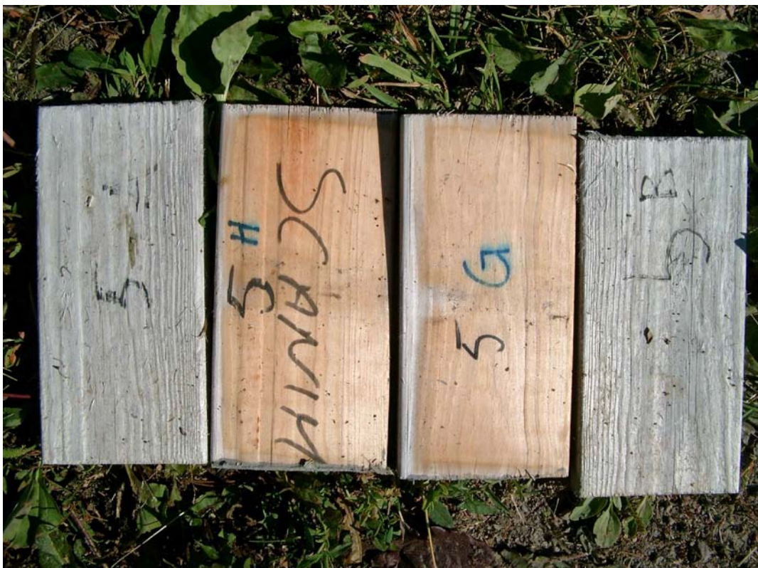
Figur 165. Furu, Scanimp, ingen overflatebehandling.
