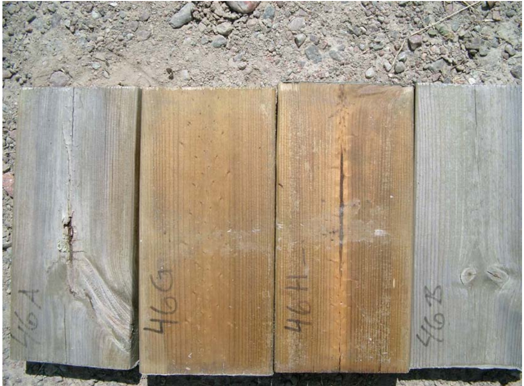
Figur 191. Furu, ACQ 1900, upigmentert vanntynnbar olje.
