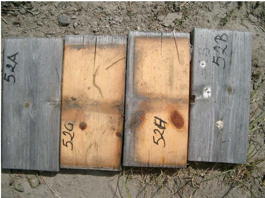
Figur 197. Furu, kjerneved, upigmentert vanntynnbar olje.
