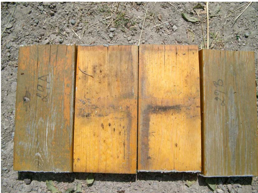
Figur 189. Furu, Tanalith M, pigmentert alkydolje.
