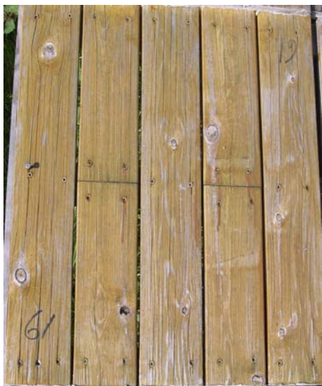
Prøve 61. Furu impregnert med Scanimp og overflatebehandlet med pigmentert vanntynnbar olje ga best resultat etter fire års eksponering.
