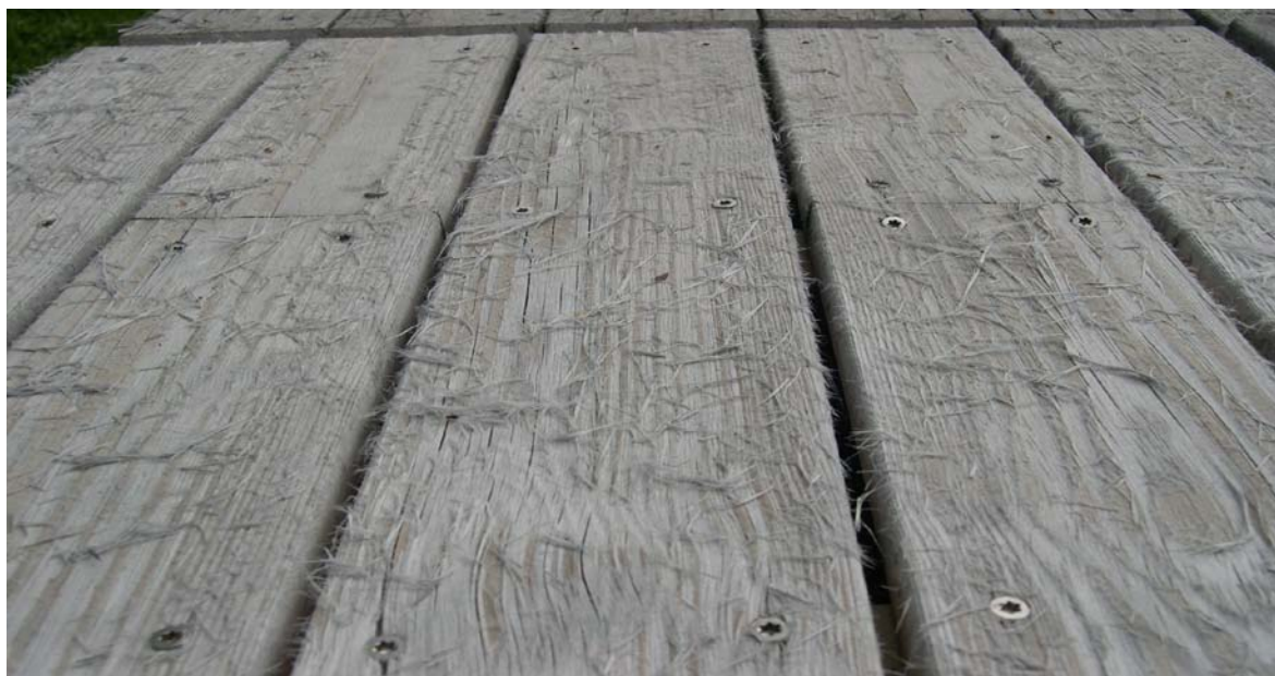
Figur 154. Eksempel på defibrering. Prøve 4, furu yteved, eksponert i fire år.
