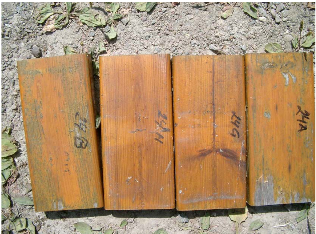
Figur 184. Gran, varmebehandlet, pigmentert alkydolje.
