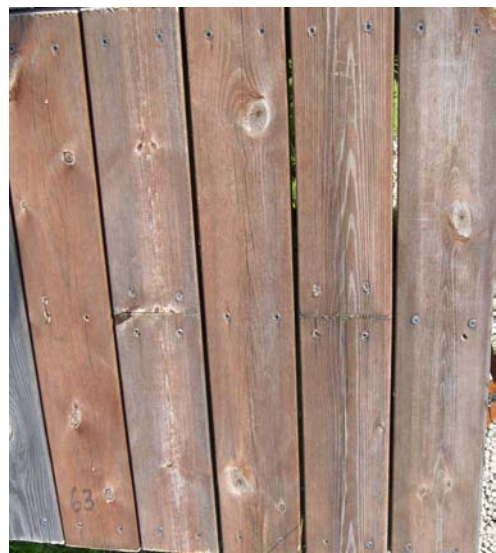
Figur 151. Royalimpregnert prøve (nr. 63) med tre års mellomrom. Venstre, juni 2002, og høyre, august 2005.
