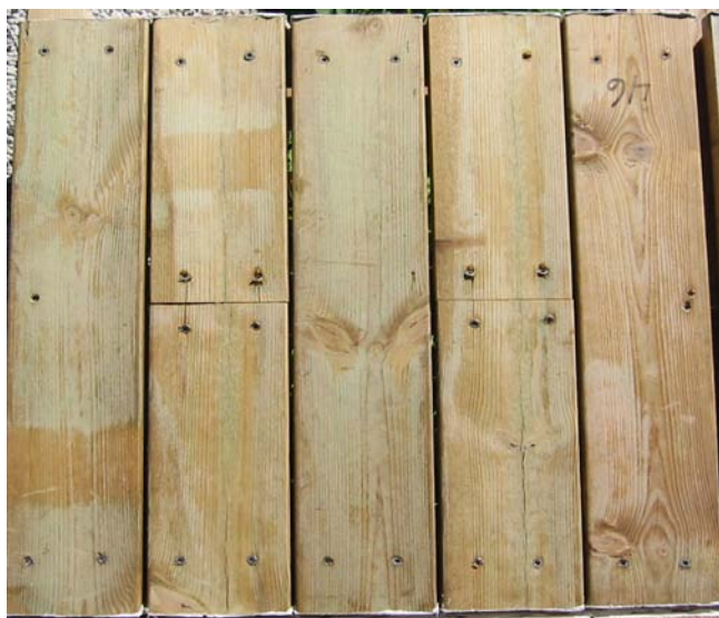
Figur 149. Prøve 46 eksponert i ett år. Overflatebehandlingen har fått et gråhvitt utseende.
