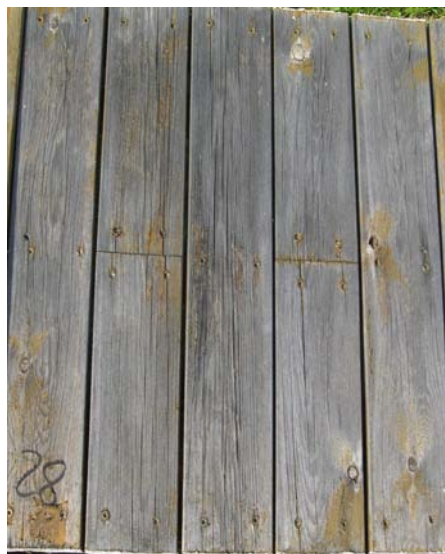
Prøve 28. Furu impregnert med furfurylalkohol og overflatebehandlet med pigmentert alkydolje tynnet i white-spirit ga dårligst resultat etter fire års eksponering.
