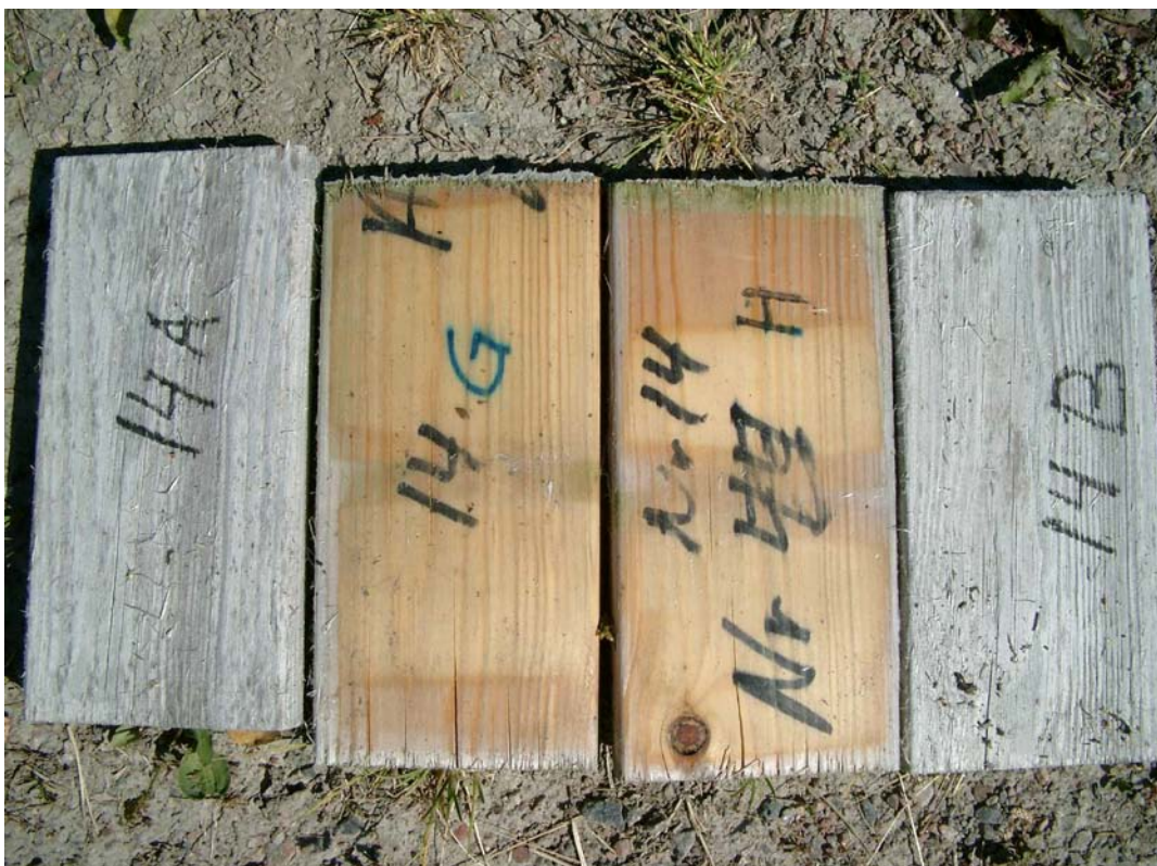
Figur 174. Furu, Tanalith M, ingen overflatebehandling.
