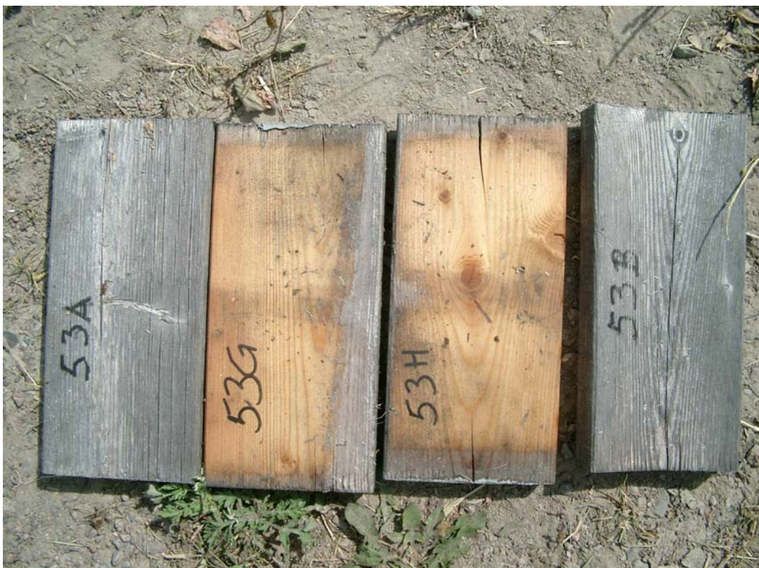
Figur 198. Lerk, kjerneved, upigmentert vanntynnbar olje.
