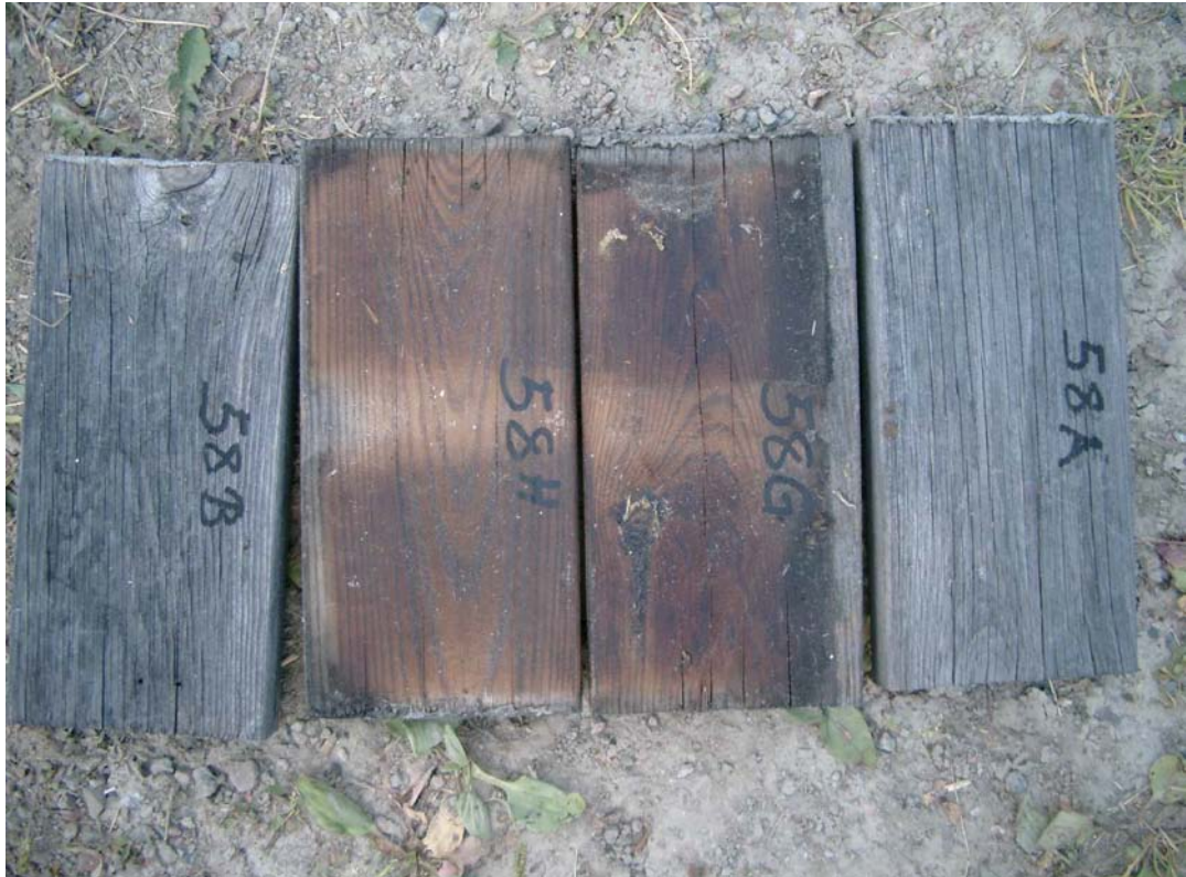
Figur 203. Furu, furfurylert, upigmentert vanntynnbar olje.
