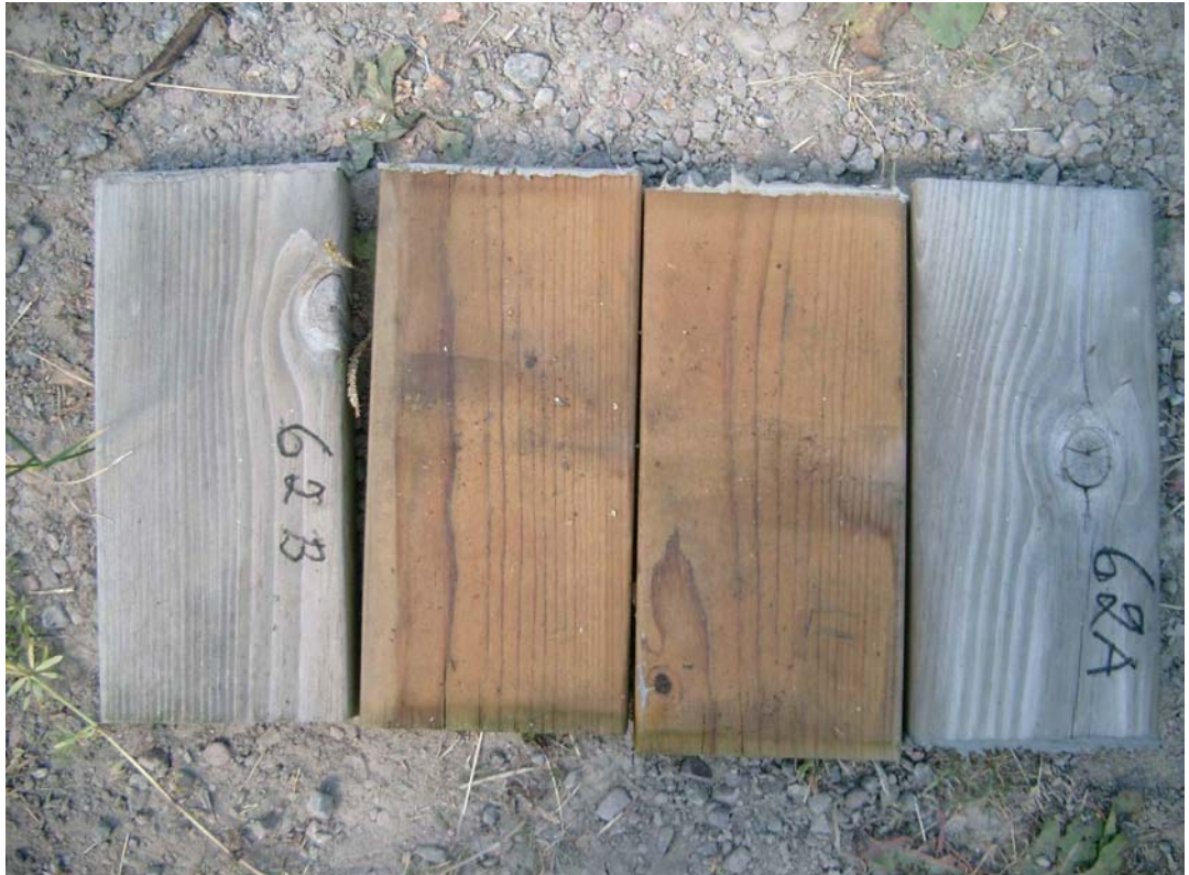
Figur 207. Furu, Royalimpregnert (klar), ingen overflatebehandling.
