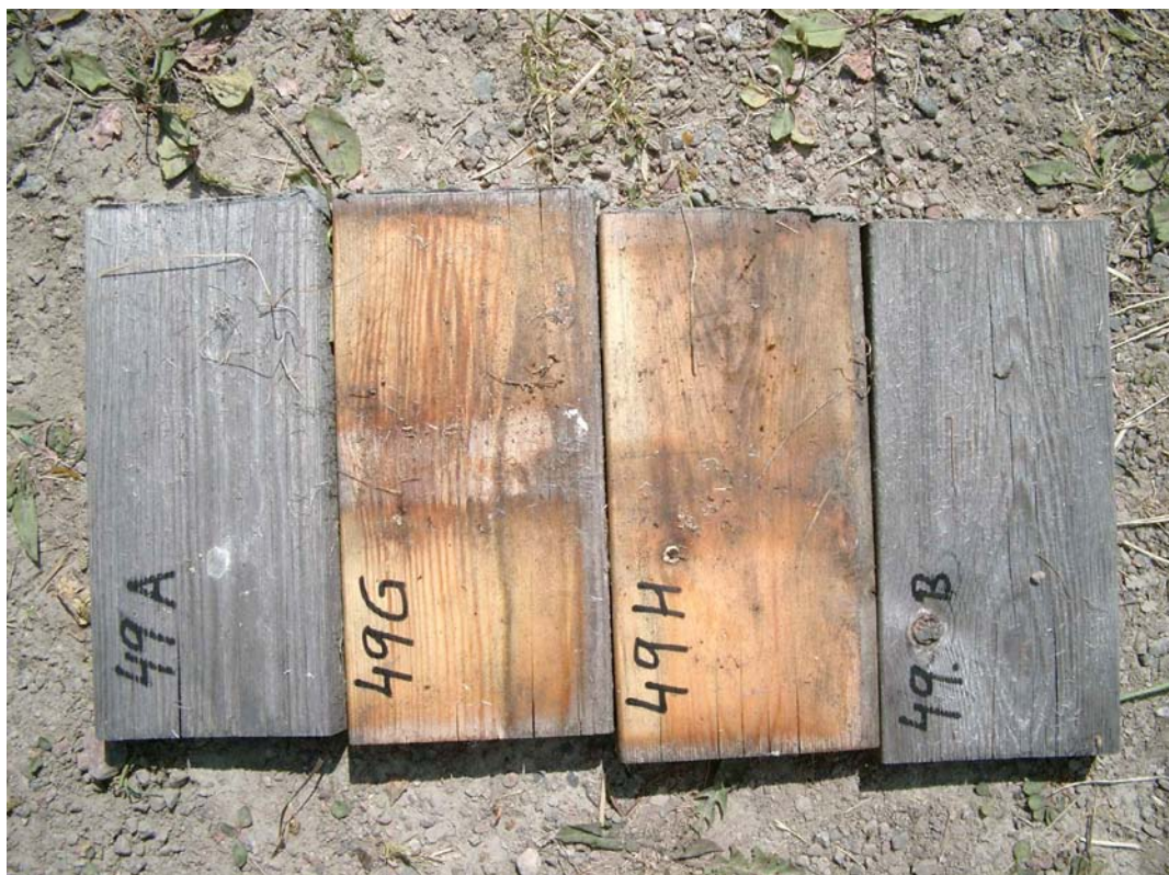
Figur 194. Furu, yteved, upigmentert vanntynnbare olje.
