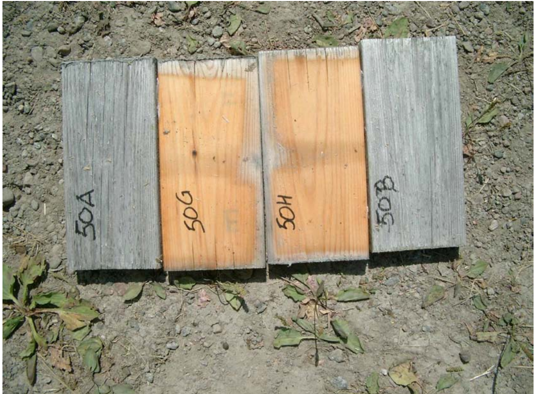
Figur 195. Furu, Scanimp, upigmentert vanntynnbar olje.
