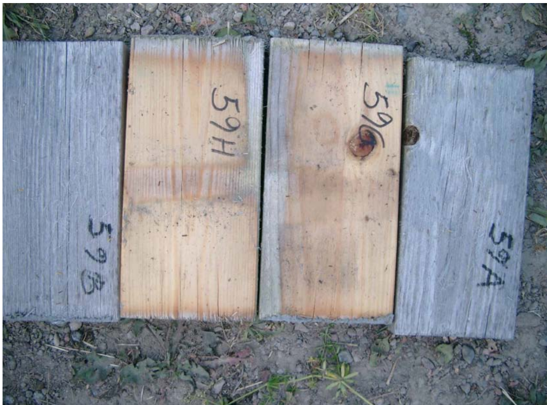
Figur 204. Furu, Tanalith M, upigmentert vanntynnbar olje.
