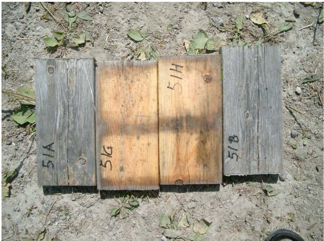
Figur 196. Furu, UltraWood, upigmentert vanntynnbar olje.
