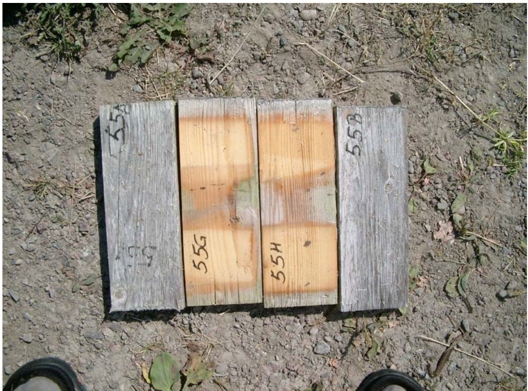
Figur 200. Gran, Gori SC 100, upigmentert vanntynnbar olje.
