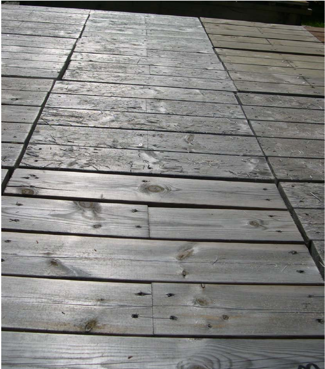
Figur 155. Defibrering etter fire års eksponering. Som bildet viser er det relativt store forskjeller på de enkelte prøvene.
