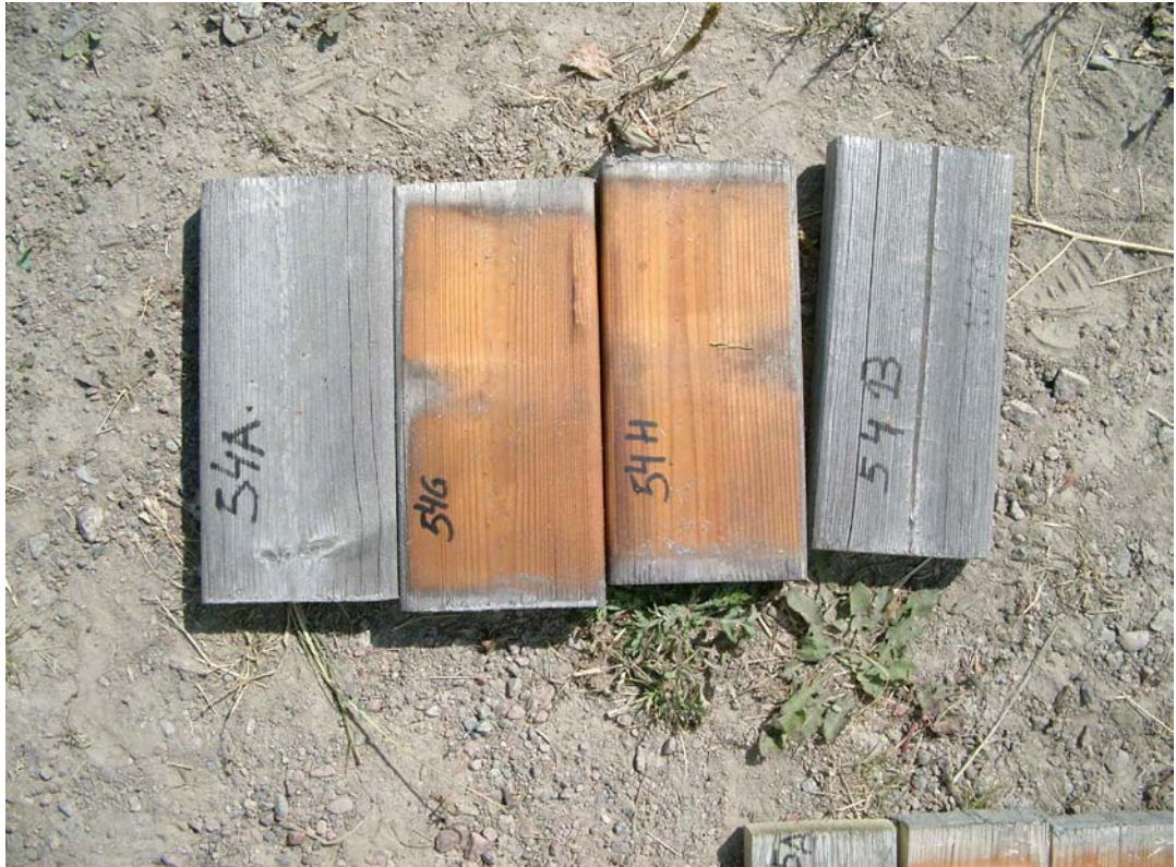
Figur 199. Gran, varmebehandlet, upigmentert vanntynnbar olje.
