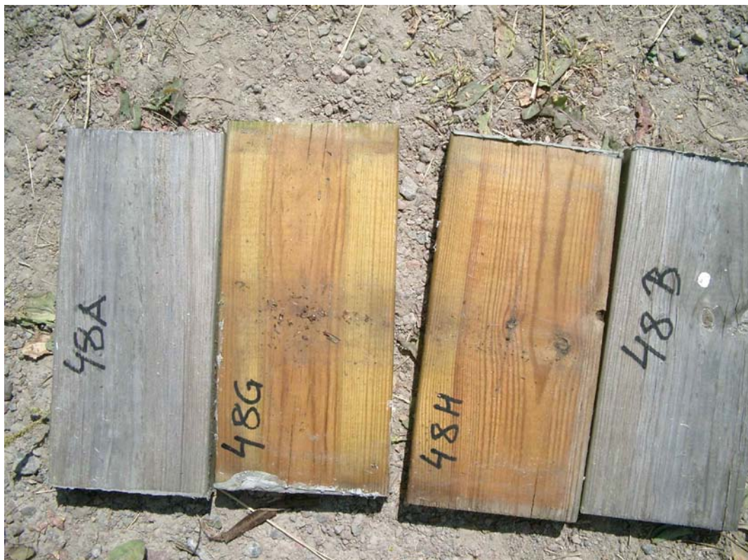
Figur 193. Furu, Wolmanith CX 8, upigmentert vanntynnbare olje.
