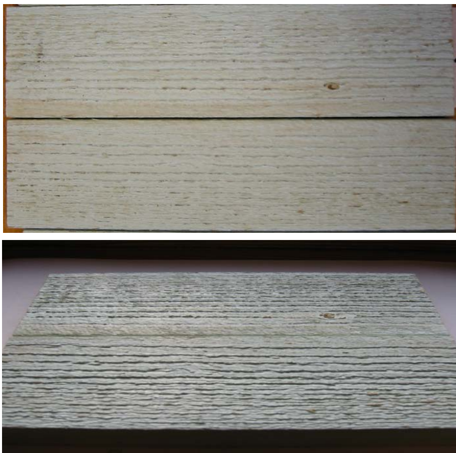
Figur 4. Vaskebretteffekt etter impregnering med superkritisk CO 2 .
