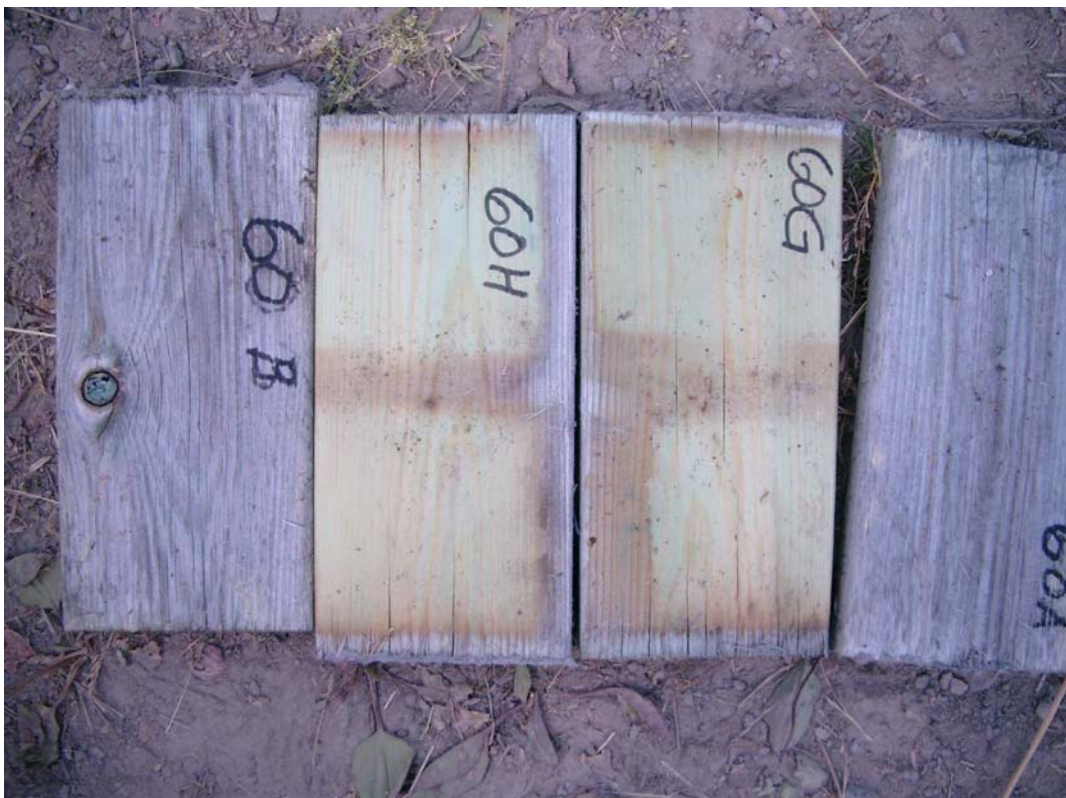
Figur 205. Furu, Tanalith M (farget), upigmentert vanntynnbar olje.
