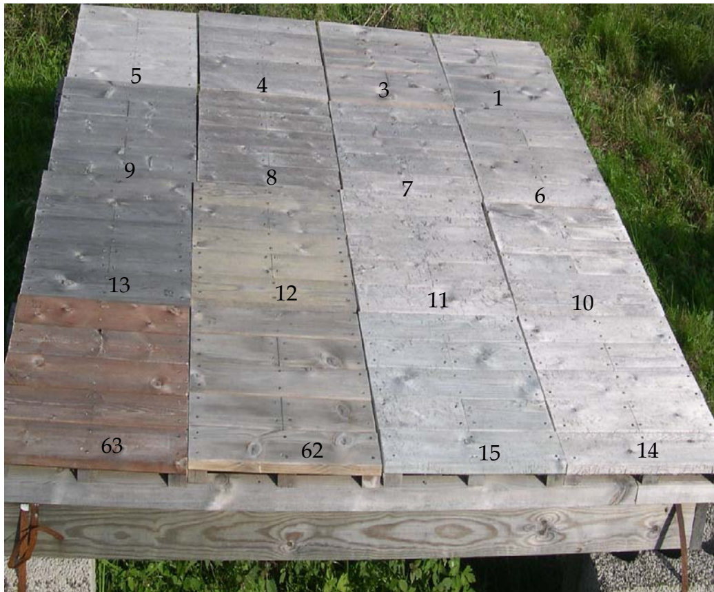
Figur 150. Utseende på terrasselemmer uten overflatebehandling etter ca. fire års eksponering i vertikal posisjon. (Prøve 2 er ikke med, da den står på et annet stativ).
