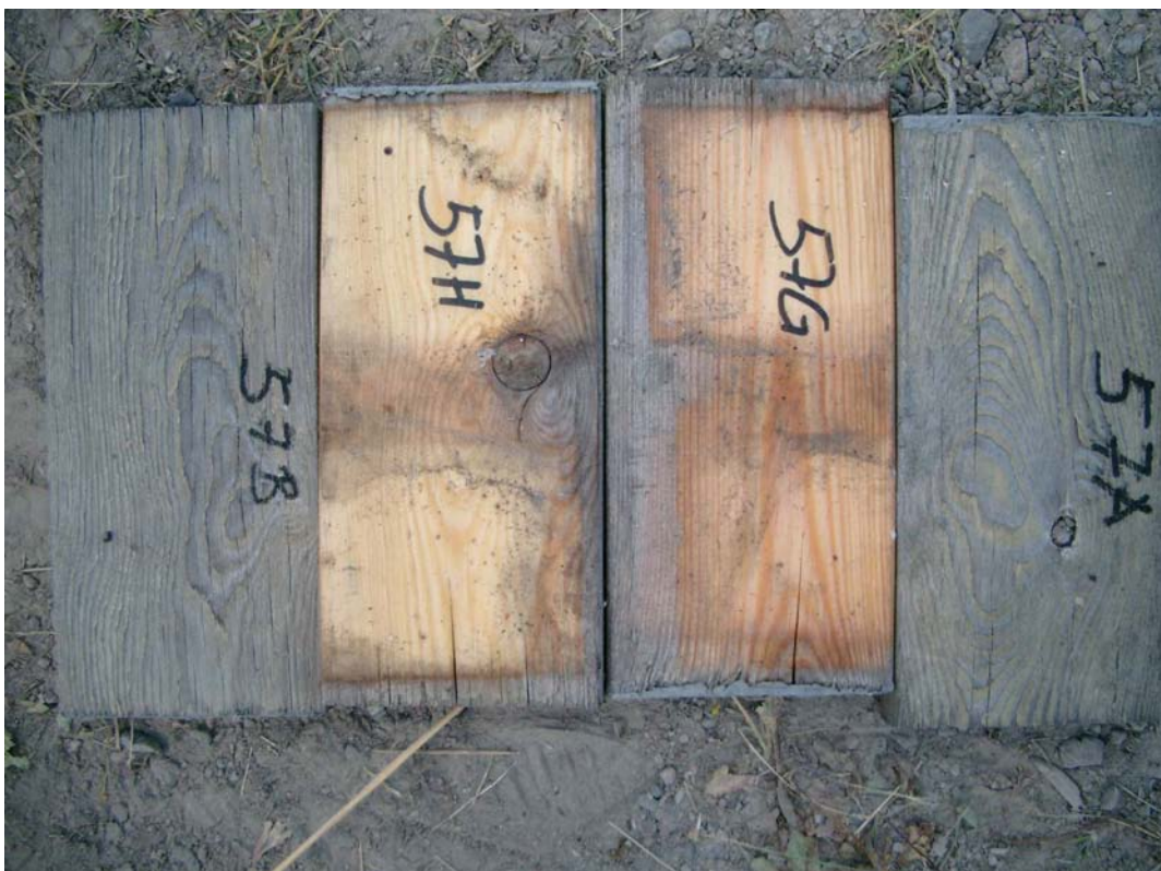
Figur 202. Furu, WPT-tre, upigmentert vanntynnbar olje.
