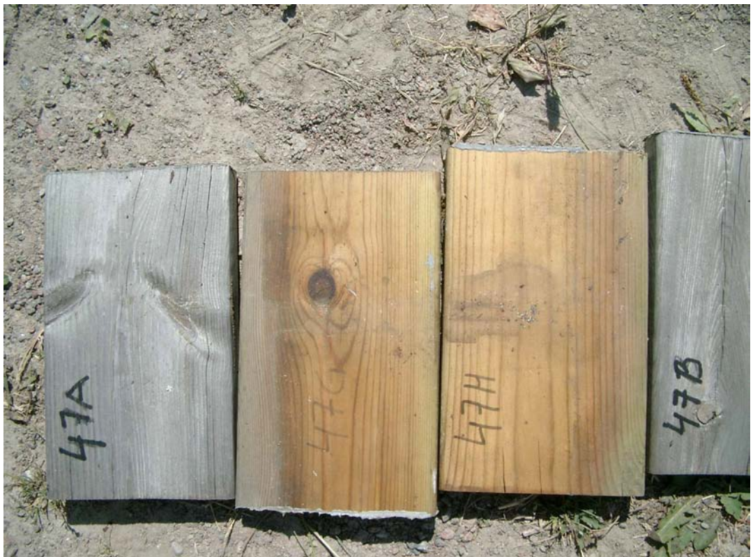
Figur 192. Furu, Tanalith E 7, upigmentert vanntynnbar olje.
