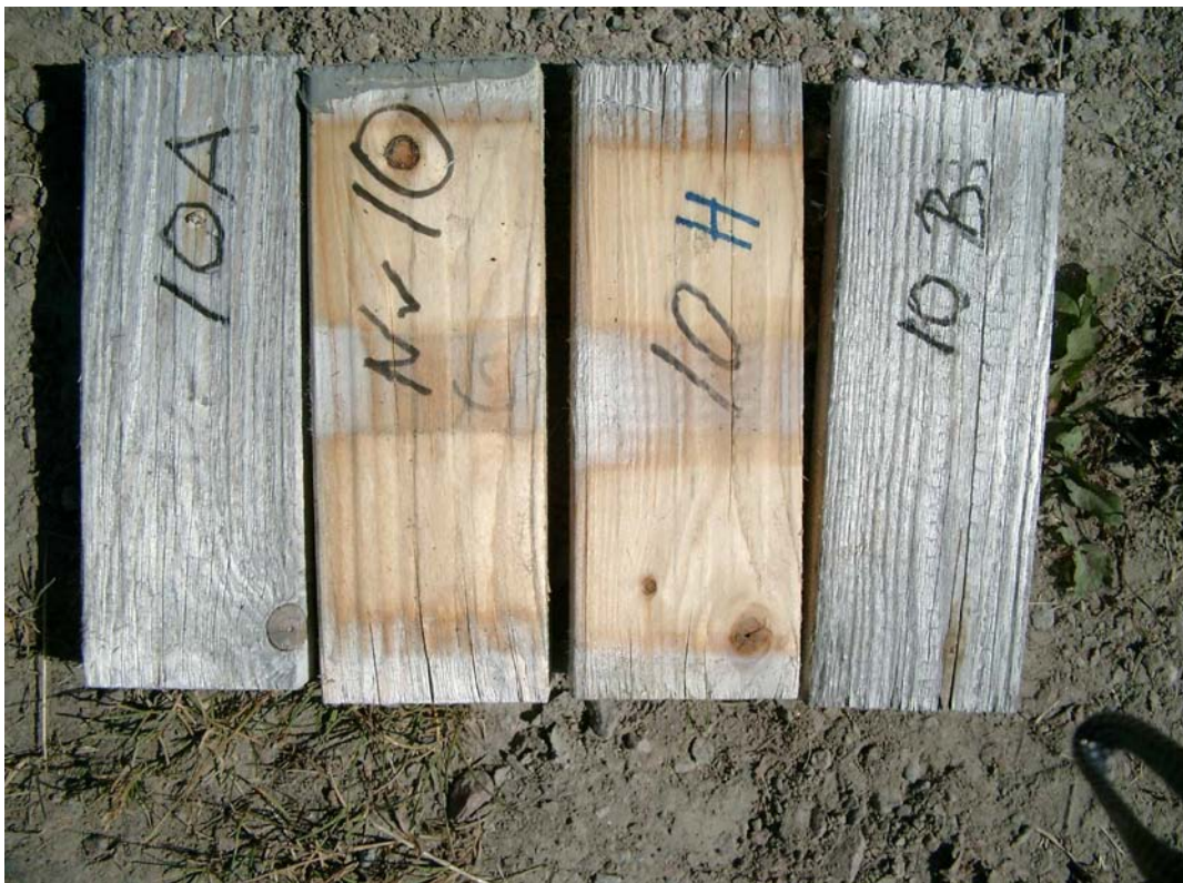
Figur 170. Gran, Gori SC 100, ingen overflatebehandling.
