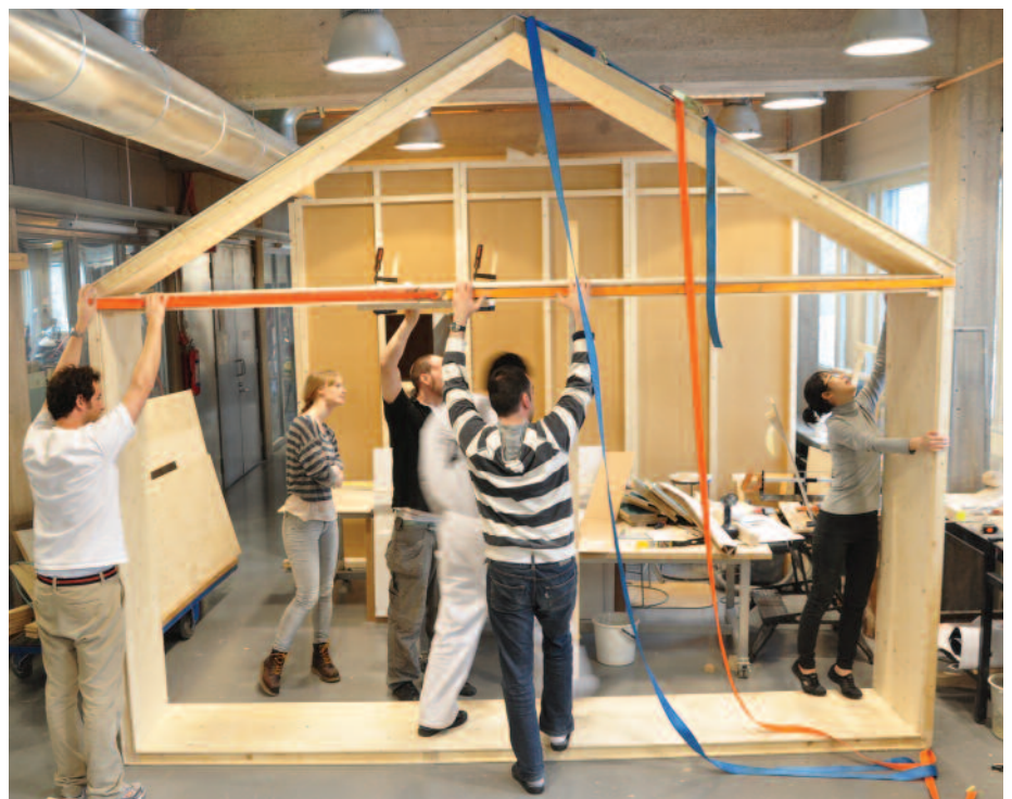
Testing av 1:1 skala ramme i verkstedet. Klarer vi å montere elementene sammen? Er rammen stabil, rigid, sterk, lett? Fungerer nylonbåndene?
