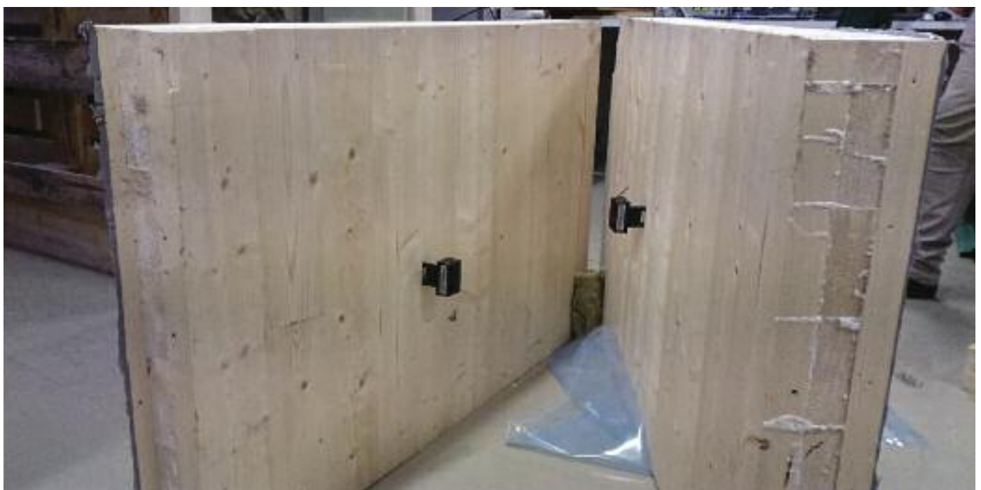
Åpning av massivtreelement etter 5 mnd.
