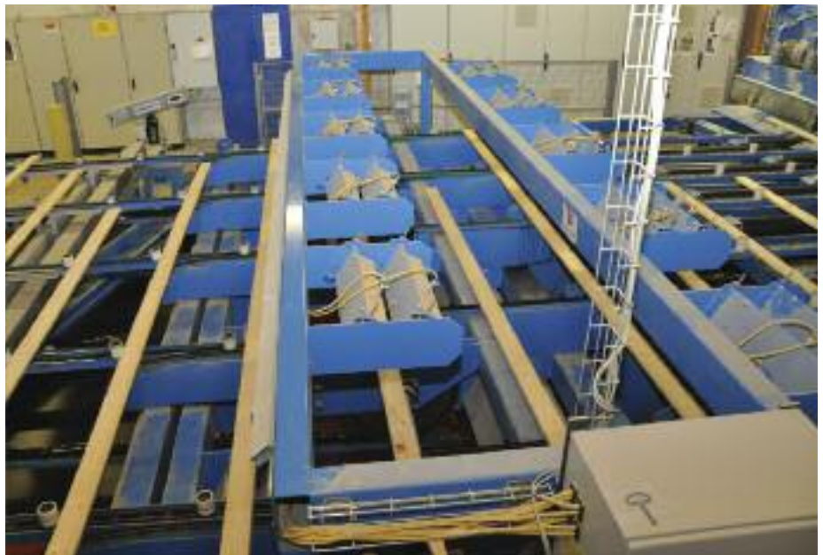
RemaSawco BoardScanner sorterer firesidig uten vending og vil få plass i de fleste sorteringsanlegg.
