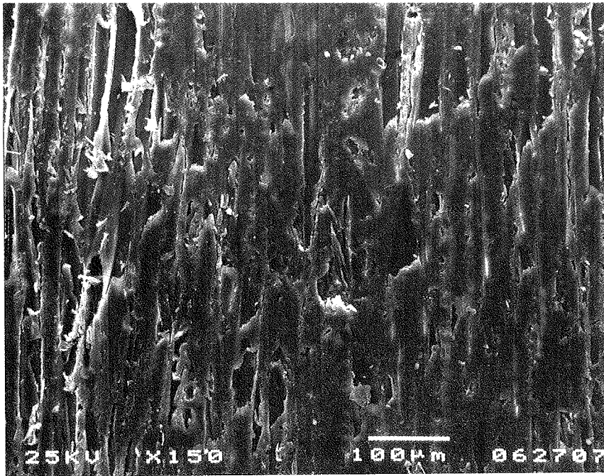
Figur 7 Furfurylmodifisert UF var på enkelte prøver uten sprekker. On some samples furfurylated UF was without cracks.
