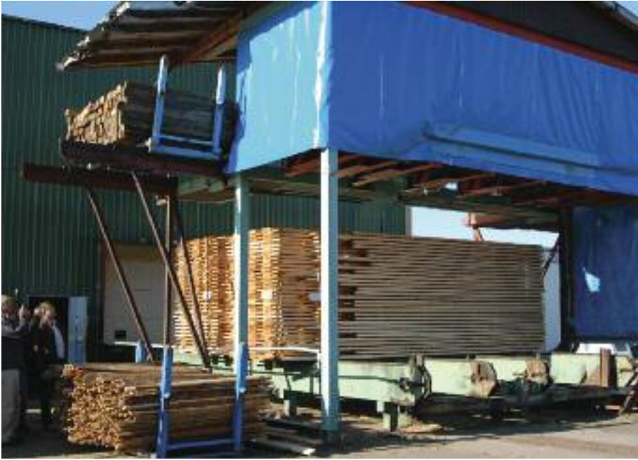
Løfter du trelastpakke opp her, så får du lagt bolster på toppen automatisk.
