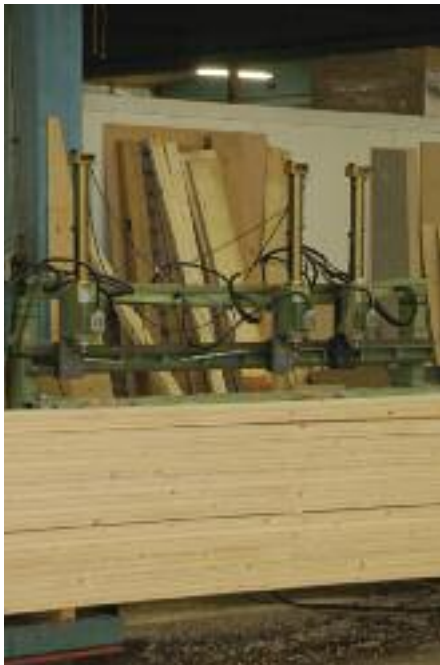
Borring av plank for silo.
