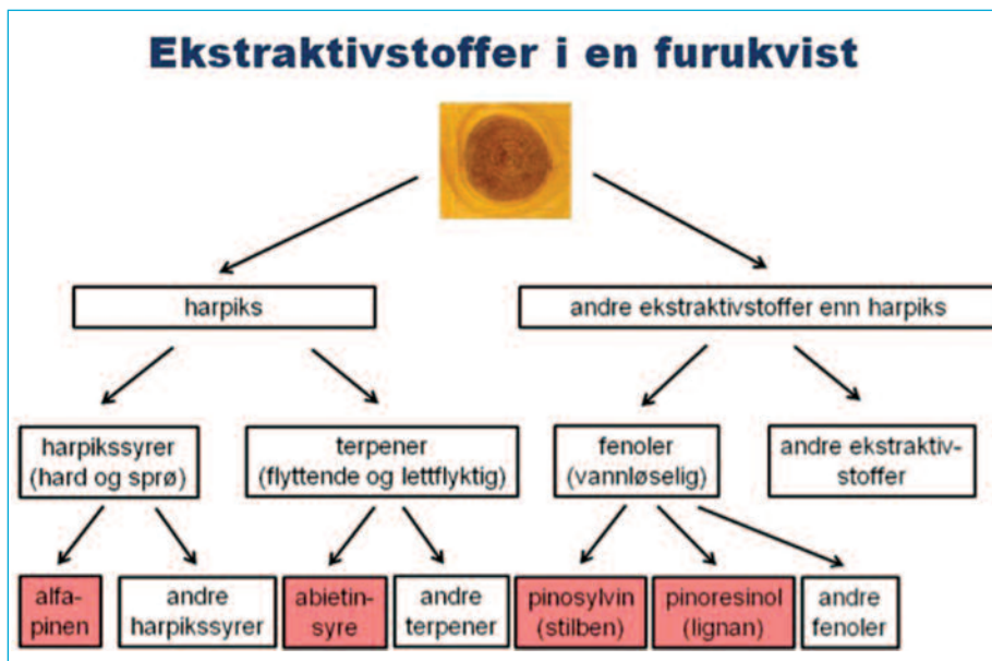
Bilde 1: Ekstraktivstoffer i en furukvist. De som er merket rødt ble testet for kvistgulning i prosjektet EkstraTre.
