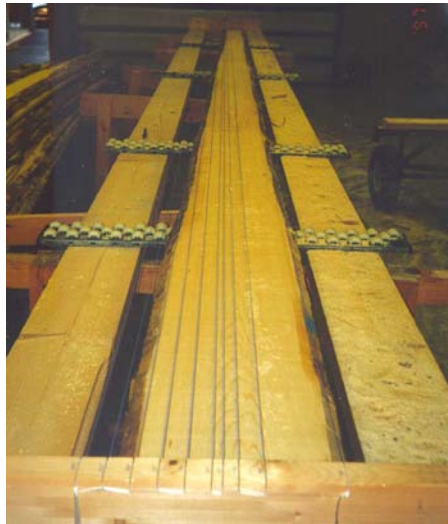
Fig. 3 Måleramme for registrering av sideborduttak. Frame for measuring the sawing yield.
