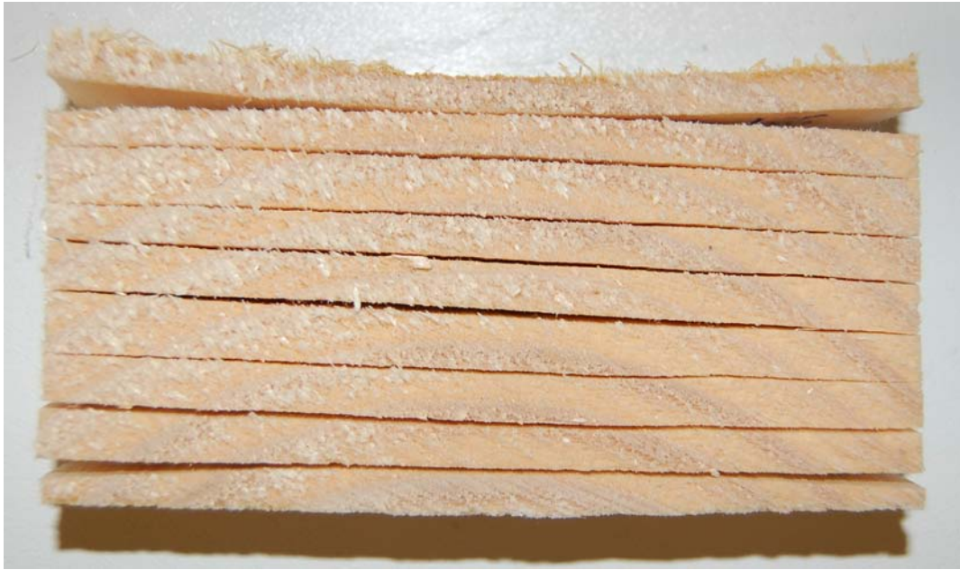
Figur 16. Eksempel på en 9-kløyoprøve (samme planke som i Figur 16) etter kondisjoneringsfase på to timer (starten på utjevningsfasen i omgang 4).
